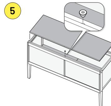
5 Mittelstange oben fixieren. Deckplatte aufsetzen. Eckverbindungen prüfen, ggf. bündig feinausrichten und anziehen bis die Schrauben bündig sind.
