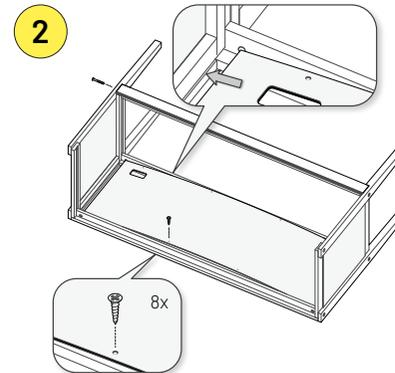
2 Die Rückwand einsetzen (optionale Kabelöffnung nach Wunsch links oder rechts). Mit acht Schrauben fixieren (PZ1). Vorderes Profil einsetzen und handfest verschrauben.
