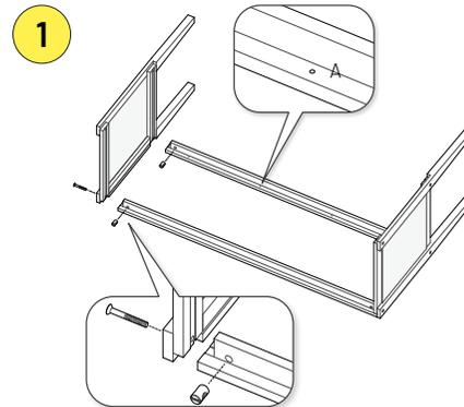
1 Seitenteile mit den hinteren Profilen verbinden. Auf die Ausrichtung der Seitenteile achten (L,R). Die kleinen Bohrungen der Profile zeigen nach innen (A). Schrauben nur handfest anziehen (SW3).
