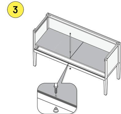
3 Sideboard aufrichten. Boden einlegen – dabei mit der Hand von unten abstützen – und Mittelstange befestigen (SW4).
